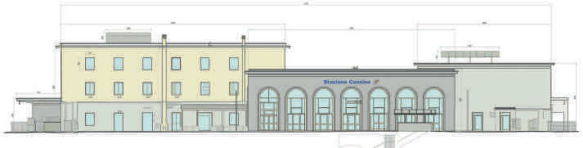
Prospetto lato Piazzale di Stazione. Evidenti i tre volumi di altezze diverse e il portico centrale con i sette archi
